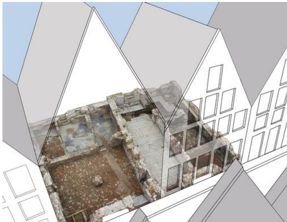
Figure 17: A visualisation sketch of the integration of the cellars on Fischstraße into the new construction projects (© Hansestadt Lübeck, Abteilung Archäologie).
